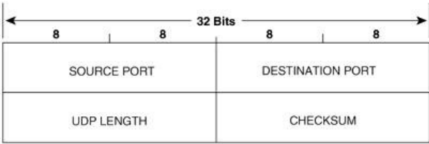
Figure 1-18. UDP header format.
